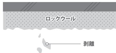
経年劣化や鳥害によって付着力が低下することでロックウールの強度が脆弱となり風や振動で剥離し落下する。
