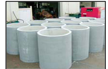
③ライニング材(代替被覆) 対象用に製造した代替被覆材。
